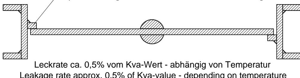
C) Anschlagleiste mit Dichteinlage / Metal stop with braided sealing
