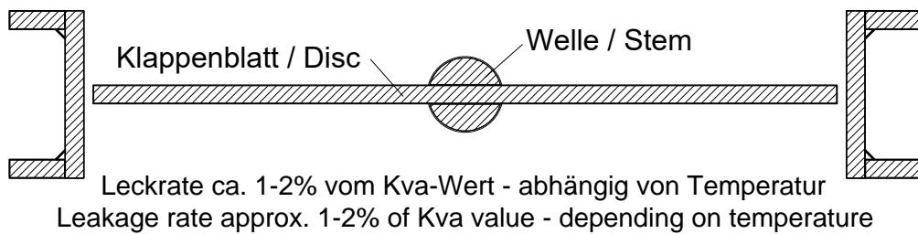
B) Anschlagleiste / Metal to Metal sealing
