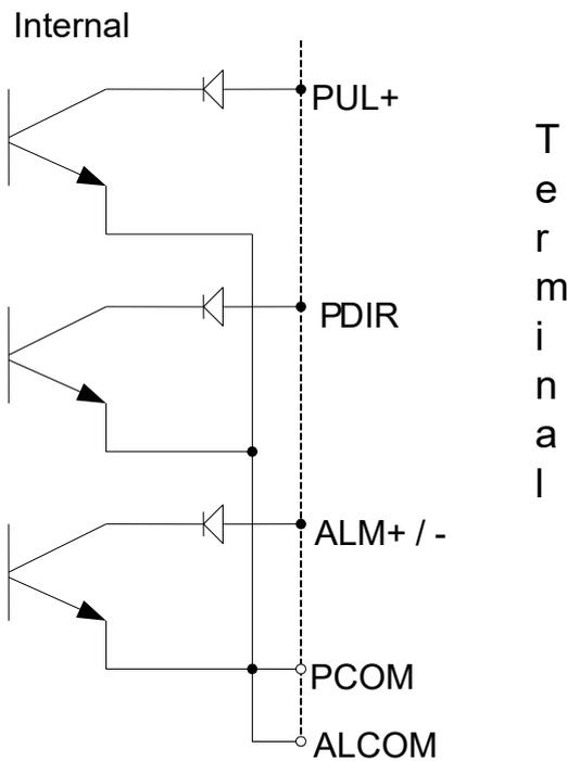
Fig 2.5 (d) Example of transistor open collector
